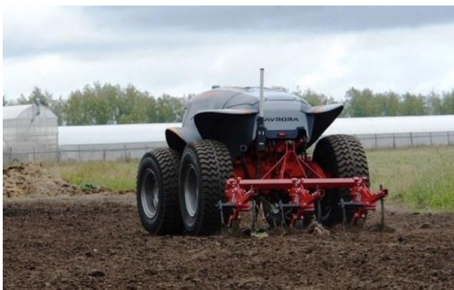
Жолоочгүй, ухаалаг Агробот системээр хөрс боловсруулж буй байдал
