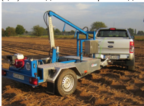
Зураг 8. Машинаар чирдэг хөрсний дээж авах техник 1
