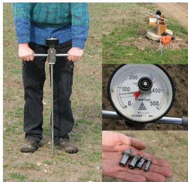
Зураг 2. Пенетромтрээр дээж авч буй байдал
