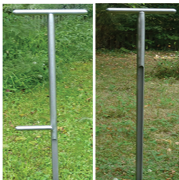
Зураг 8. Машинаар чирдэг хөрсний дээж авах техник 1
