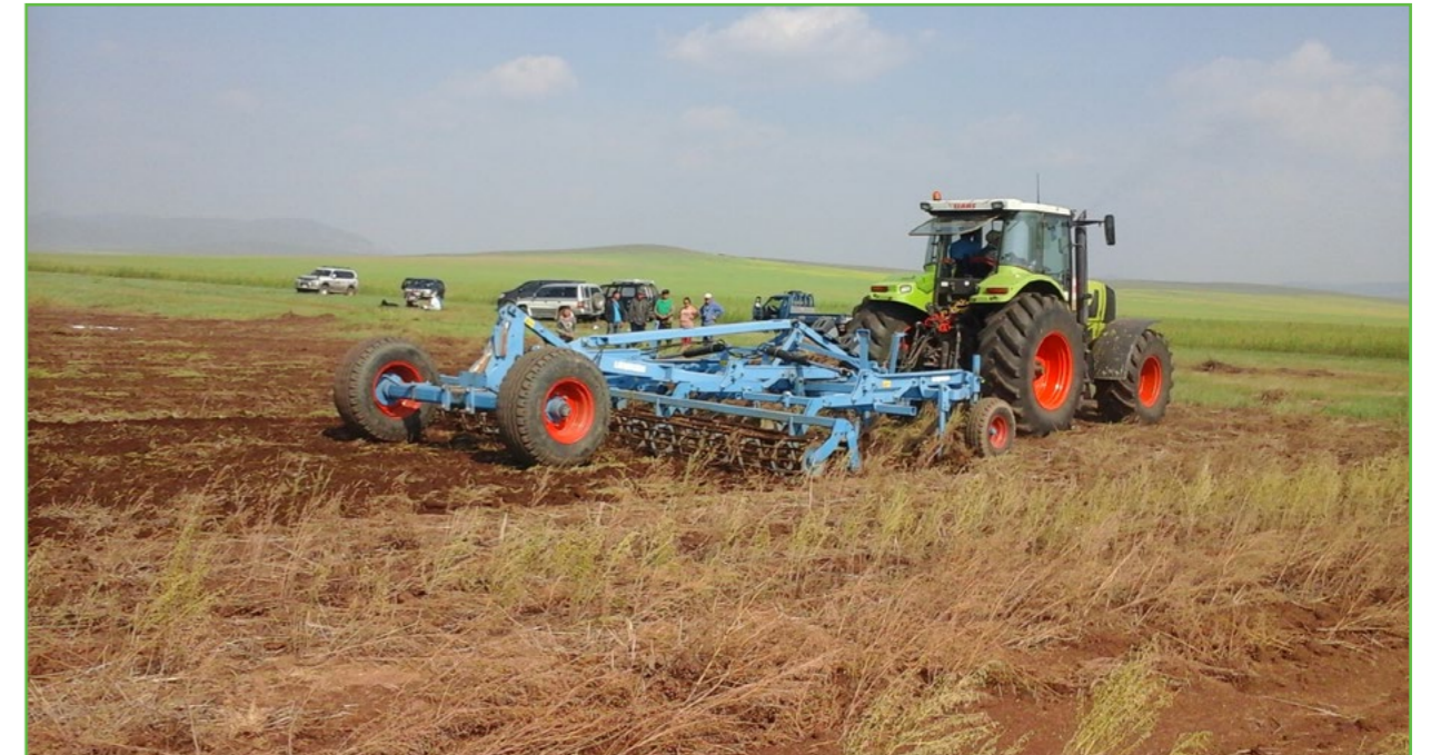
Зураг 76: Төв аймгийн Угтаалцайдам суманд Клаас Атлас 946+Смарагд 9/400 угсраагаар дугуйн хийн даралтыг өөрчилж шатахуун зарцуулалтыг тодорхойлж байгаа нь
