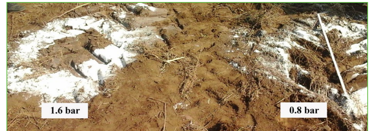
Зураг 77: Тракторын дугуйн хийн даралтыг өөрчилж талбайд үзүүлэх даралтыг тодорхойлсон байдал
