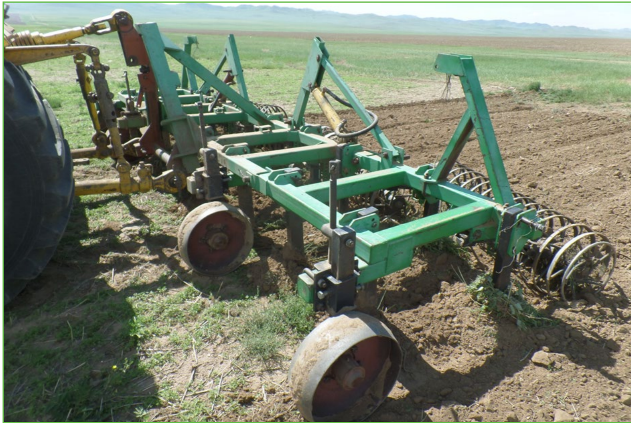
Зураг 13: Талбайн хог ургамлыг устгах зорилгоор гүн сийрүүлүүр, ороомгон борнойт агрегат ашиглан хөрс боловсруулалт хийж буй байдал
