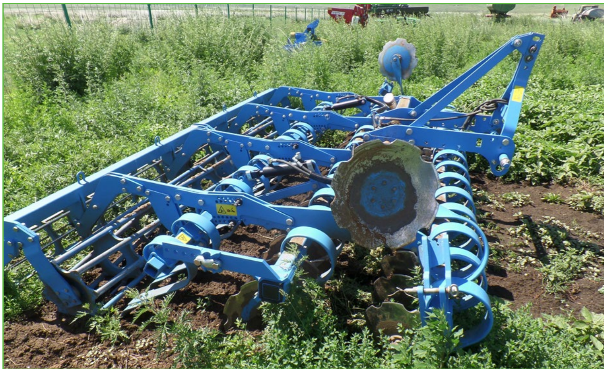
Зураг 39: Хөрс боловсруулах машиныг зориулалтын дагуу хадгалалтанд тавиагүй байдал
