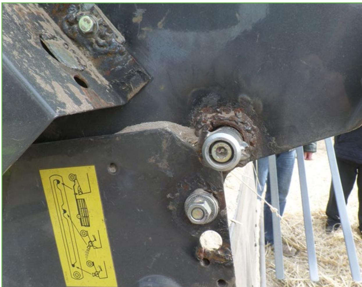
Зураг 35: Сүрэл хэрчигчийг буруу гагнасан байдал
