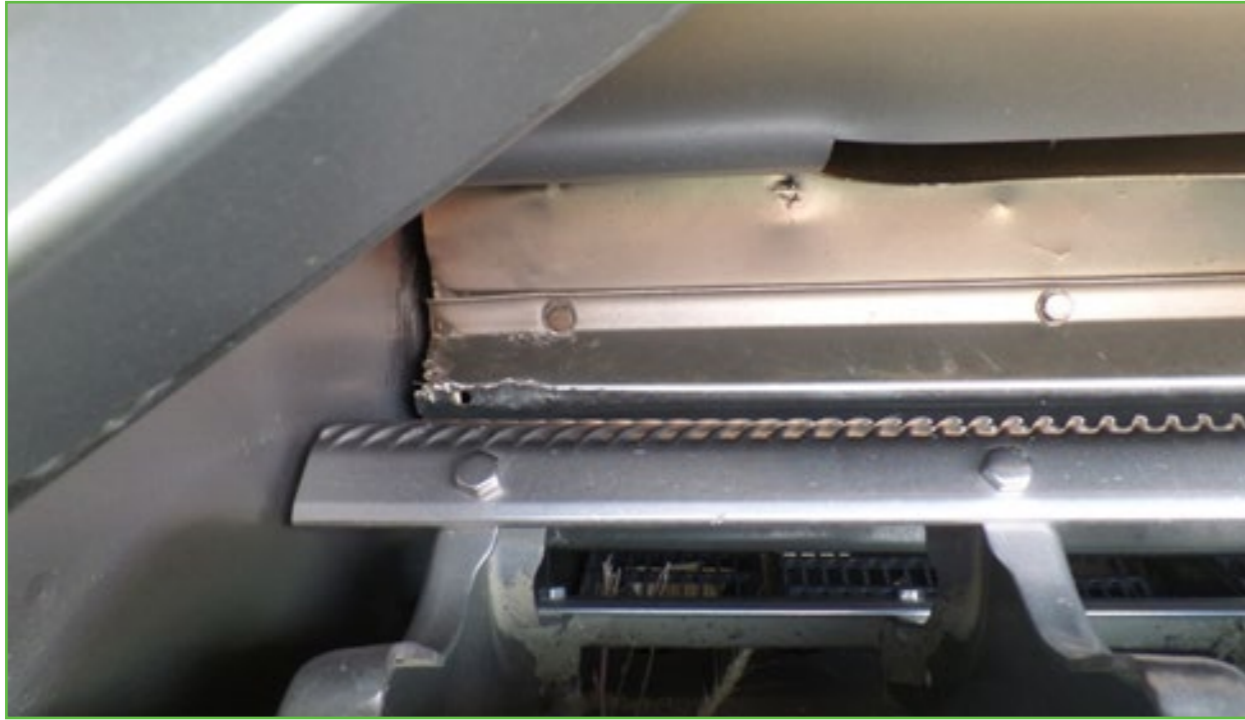
Зураг 38: Чанаргүй засварласан сүрэл чиглүүлэгч хүрдийг удаан ашиглахгүй байх
