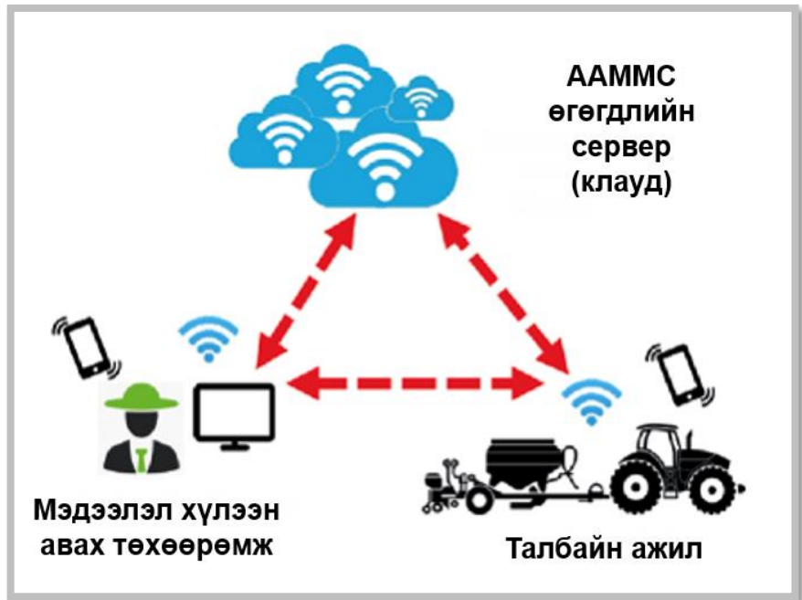
Зураг 5: Аж ахуйн менежментийн мэдээллийн систем (ААММС)-тэй бөгөөд талбайн машинууд болон мэдээлэл хүлээн авах хөдөлгөөнт төхөөрөмжүүдтэй холбогдсон клауд компьютеринг (бүдүүвч бэлтгэсэн: Грийпэнтрог)
