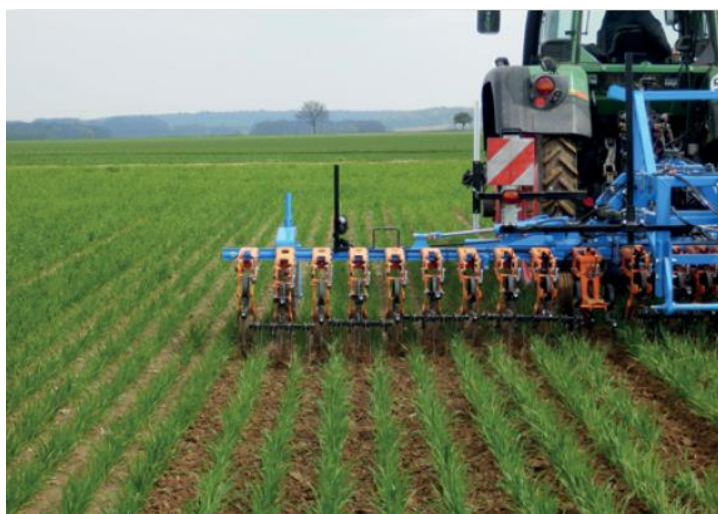
Зураг 5: Үр тариаг өргөн мөрөөр тариалж, эгнээ хоорондын 25 см зайд камерын удирдлагатай багажаар сийрүүлэлт хийх боломжтой (Эх сурвалж: Маркус Мюке, Нийдерзаксен мужийн ХАА-н танхим)
