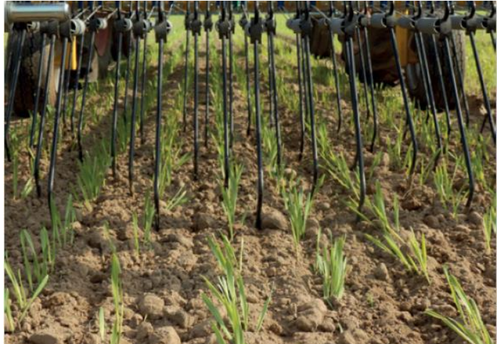
Зураг 3: Үр тарианы таримлыг нэг навчтай үед шүдэт борнойгоор борнойдож болох боловч тохиргоог нь зөв хийхгүй бол таримлын хорогдол үүсгэх эрсдэлтэй. (Эх сурвалж: Маркус Мюке, Нийдерзаксен мужийн ХАА-н танхим)
