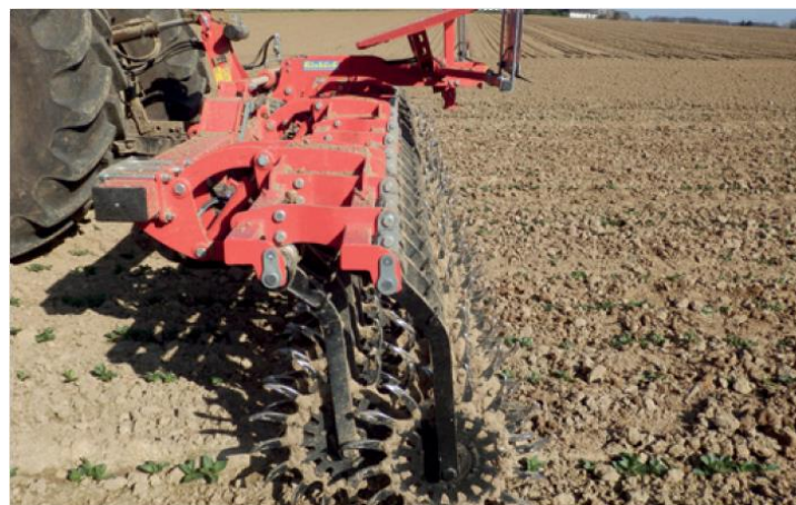
Зураг 3: Од хэлбэрийн эргэдэг цант сэндчилүүр лагтсан, өрөмтсөн хөрсийг сийрүүлэхээс гадна хог ургамал устгах чадвартай (Эх сурвалж: Маркус Мюке, Нийдерзаксен мужийн ХАА-н танхим)
